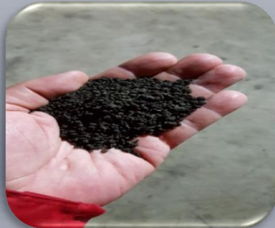
%2 Nem 3500 kcal Kurutulmuş arıtma çamuru
