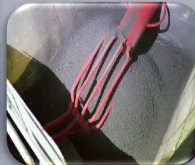
%2 Nem 3500 kcal Kurutulmuş Arıtma Çamuru
